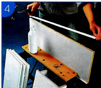
4 Кромки полок снабжают кромочными накладками. Цоколь крепят к нижней полке на клею и шурупах.
