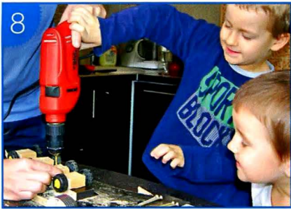
8 Сверлим отверстия для крепления саморезами колёс к основе.
