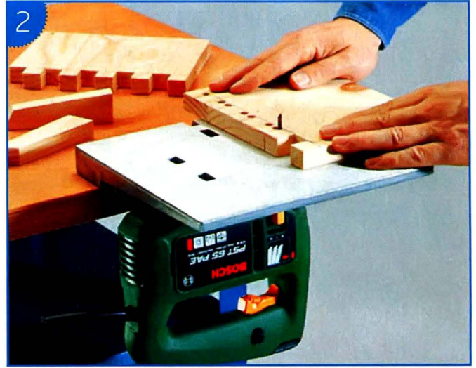
2 Электроробзиком выполните необходимые пропилы.
